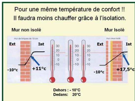
Dans la maison isolée la température de la paroi sera de  $17,5^{\circ}\text{C}$ . Dans la maison non isolée la paroi intérieure sera à une température de  $11^{\circ}\text{C}$ . La température de confort devra donc être plus élevée dans la maison non isolée et il faudra donc la chauffer beaucoup plus.
