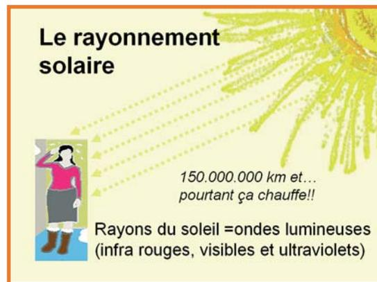
Le rayonnement va toujours du plus chaud au plus froid. Une simple fenêtre plus froide va recevoir le rayonnement instantanément même à plusieurs mètres.
